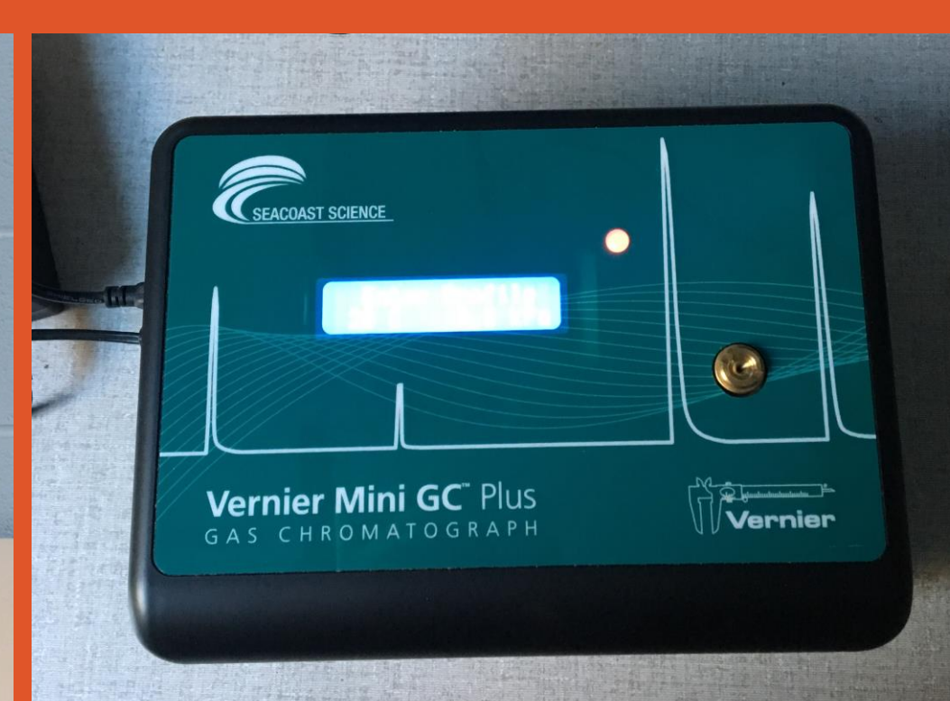
Figure 3. The Vernier Mini GC Plus Gas Chromatograph. ( 5" x 7")
